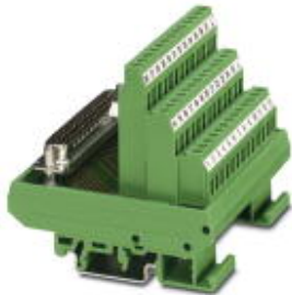
VARIOFACE-Modul, mit Schraubanschluss und D-Subminiatur-Stiftleiste, zur Montage auf NS 35/7,5 oder NS 32, Polzahl 37
