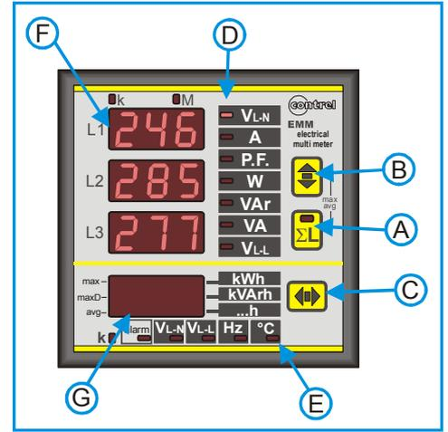
Die Integration für die Berechnung der durchschnittlichen Werte wird beim Einschalten des Messgeräts synchronisiert. Betätigen Sie die **A**- und **B**-Tasten ein weiteres Mal, wenn Sie weitere Messwerte bestimmen möchten. Wenn keine Taste gedrückt wird, kehrt das Messgerät automatisch nach 10 Sekunden in den Darstellungsmodus zurück.
