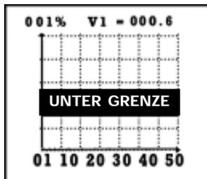
Die harmonische Analyse wird nicht durchgeführt, wenn die Spannungswerte um 5 % kleiner als die Endskala, oder wenn die Stromwerte kleiner als 0,5% sind. Unter diesen Bedingungen wird am Bildschirm die Meldung „Unter dem Grenzwert“ angezeigt.
