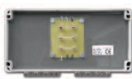
Abb.: Spannungswandler ohne Gehäusedeckel mit Sicherungen
