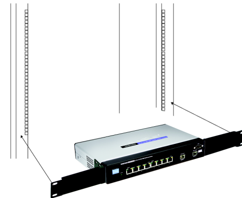
Abbildung 3-3: Montieren des Switches im Gestell
