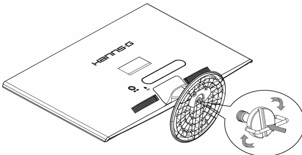
Рисунок 1: Установка и демонтаж основания
